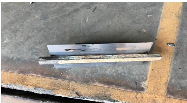
F5 – Nivelador da altura entre a junta JEENE e o piso
